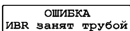
Рис. 7 – Сообщение об ошибке при попытке установки режима измерения дополнительной температуры, если в соответствующем трубопроводе задано измерение (меню СИСТЕМА ) температуры теплоносителя
